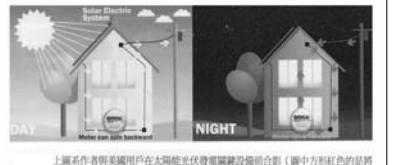
上圖系作者與美國用戶在太陽能光伏發電電網設備前合影(圖中方紅色的起點線或變成交流電的變壓器，圓形的是可以雙向轉動的專用電錶)，下圖是太陽能光伏發電與家庭原有電網的聯繫及配合使用方式。
